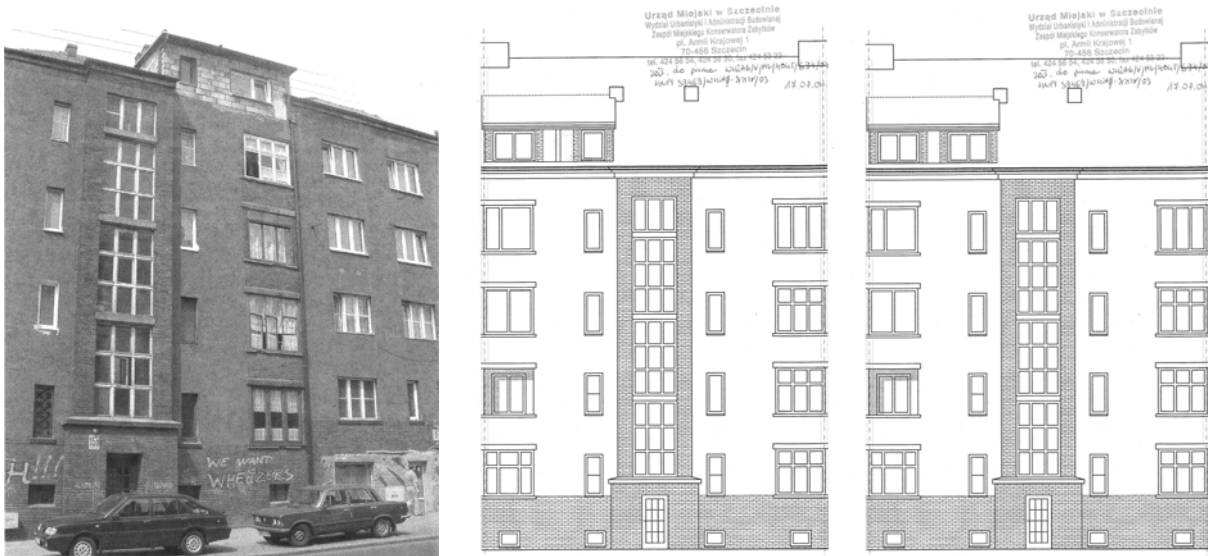
Rys. 6. Adaptacja poddasza na mieszkanie, Szczecin, ul. Kołłątają; od lewej – zdjęcie fragmentu elewacji sąsiedniej klatki kamienicy, po środku – proponowane przez projektanta rozwiązanie lukarny, po prawej – zmiana w wyglądzie projektowanej lukarny po konsultacjach z Zespołem Miejskiego Konserwatora Zabytków (materiały własne, E. Goczyńska).
