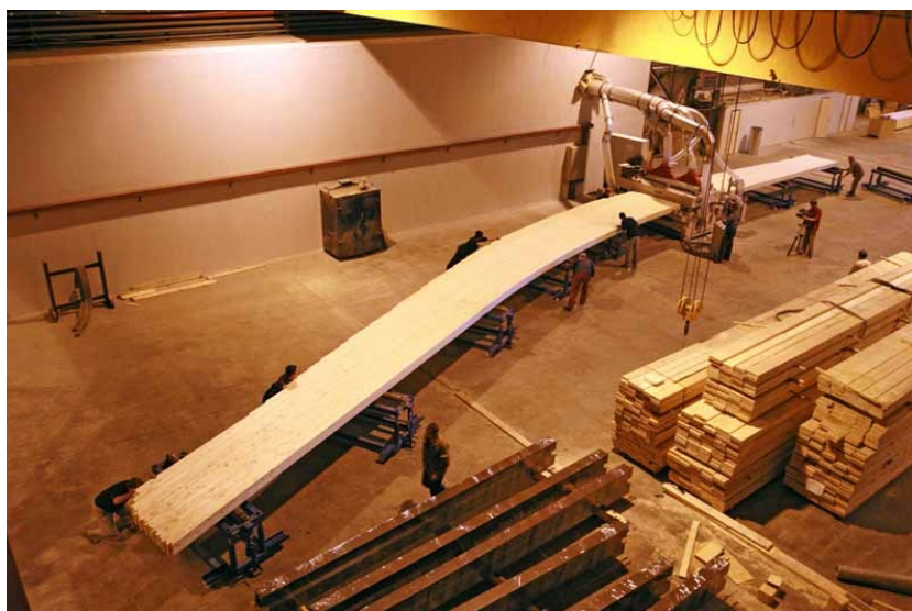
Rys. 2. Wytwarzanie elementu konstrukcyjnego z drewna klejonego [10].
