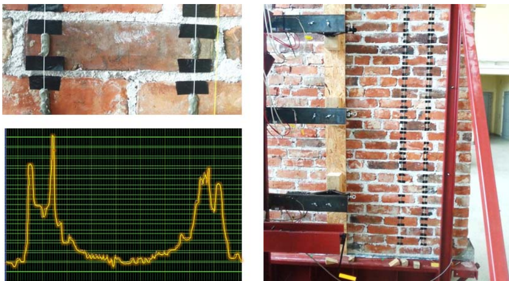
Rys. 6. Widok stanowiska badawczego oraz przykładowy wykres dystrybucji odkształceń w początkowej fazie przyładania obciążenia na ścianę murową.
